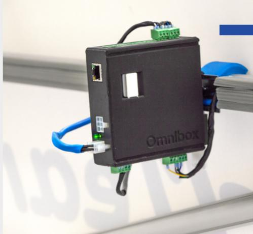
Il s'agit d'un périphérique fixe permettant l'interfaçage simple et de façon quasi transparente entre les robots mobiles, les machines existantes et autres équipements de l'environnement de travail, simplifiant ainsi la mise en œuvre de la solution de robotique mobile. Le développement de passerelles de communication vers les protocoles existants dans les industries, permet à l'OmniBox un interfaçage orienté métier, dédié au contrôle de la flotte de robots mobiles.
