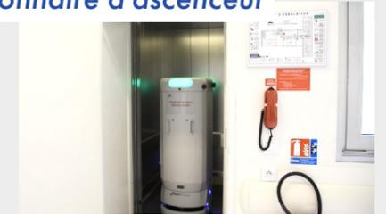
Cet équipement transforme votre ascenseur en ascenseur connecté en permettant l'interfaçage avec le robot. Le robot mobile peut ainsi l'utiliser sur plusieurs étages en toute autonomie.
