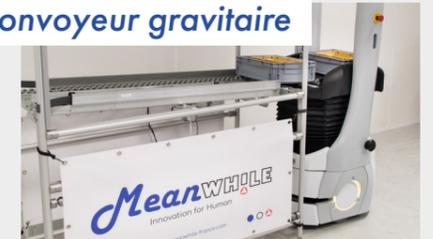
Afin d'assurer une solution aussi économique et efficace que possible, il est possible d'interfacier les robots mobiles avec des convoyeurs à rouleaux gravitaires, équipés de l'OmniBox.
