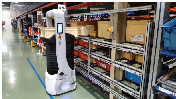
Le modèle XuP-Lift en train de décharger une caisse
